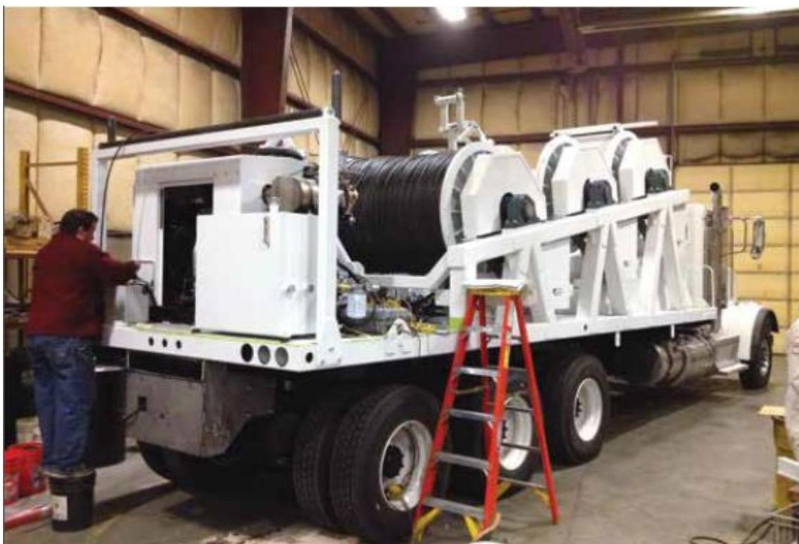
Установка для протяжки и натяжения кабеля с тремя барабанами ODP 100-3 предназначена для подачи кабеля через каретки с заданной силой натяжения. Каждый барабан можно подключать или отключать, чтобы в протяжке кабеля был задействован один барабан или несколько. Установка создает момент 25,874 Н·м.
